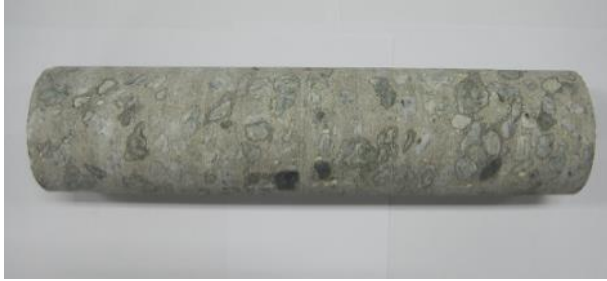
รูปที่ 10 ตัวอย่างแท่งทดสอบที่เจาะมาจาก โครงสร้างจริง
