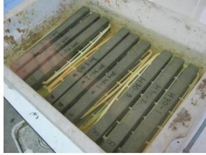
รูปที่ 7 แท่งมอร์ตาร์และเครื่องมือวัดความยาวของแท่งตัวอย่างทดสอบ (length comparator)
