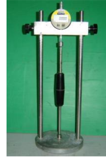
รูปที่ 7 แท่งมอร์ตาร์และเครื่องมือวัดความยาวของแท่งตัวอย่างทดสอบ (length comparator)
