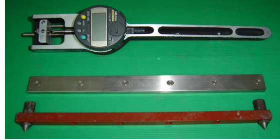
รูปที่ 11 เครื่องมือวัดความยาวแบบ Contact gauge
